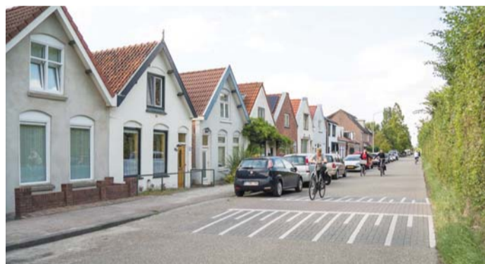
Príklad stavebného spomaľovacieho prahu so sklonom rámp dimenzovaným podľa dovolenej rýchlosti na ulici. Je komfortné cezeň prechádzať práve touto rýchlosťou – nie je nutné spomaľovať takmer na nulu, ako v prípade našich obľúbených žltociernych retardérov, ktoré navyše pri prejazde búchajú. Stavebný spomaľovací prah je komfortný na prejazd aj pre cyklistov či autobusy.
